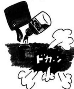
アルコール・ガソリン・灯油などの揮発性の高い危険物を流すと下水管の中で爆発したり、管を破損することがあります。
