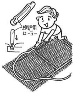
四辺をそれぞれ洗濯ばさみなどで仮留めしてから、ローラーで網を溝に押し込みます。
