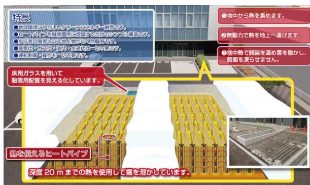
写真:地中熱ヒートパイプ融雪システム
