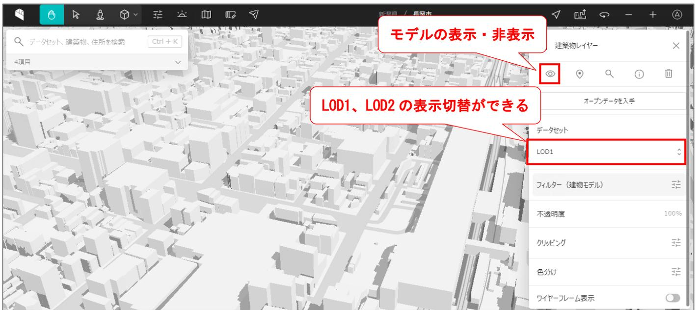
LOD1：直方体の組み合わせで構成されたモデル
