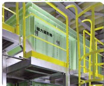
破碎ごみの中から磁石の力によって鉄類を回収します。
