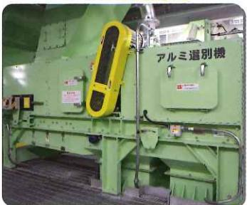
うず電流により、破碎ごみの中からアルミ類を選別します。
