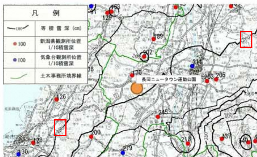
図 7-1-2 積雪荷重参考資料(新潟県：1/10 確率積雪マップ，平成 15 年 10 月より)
