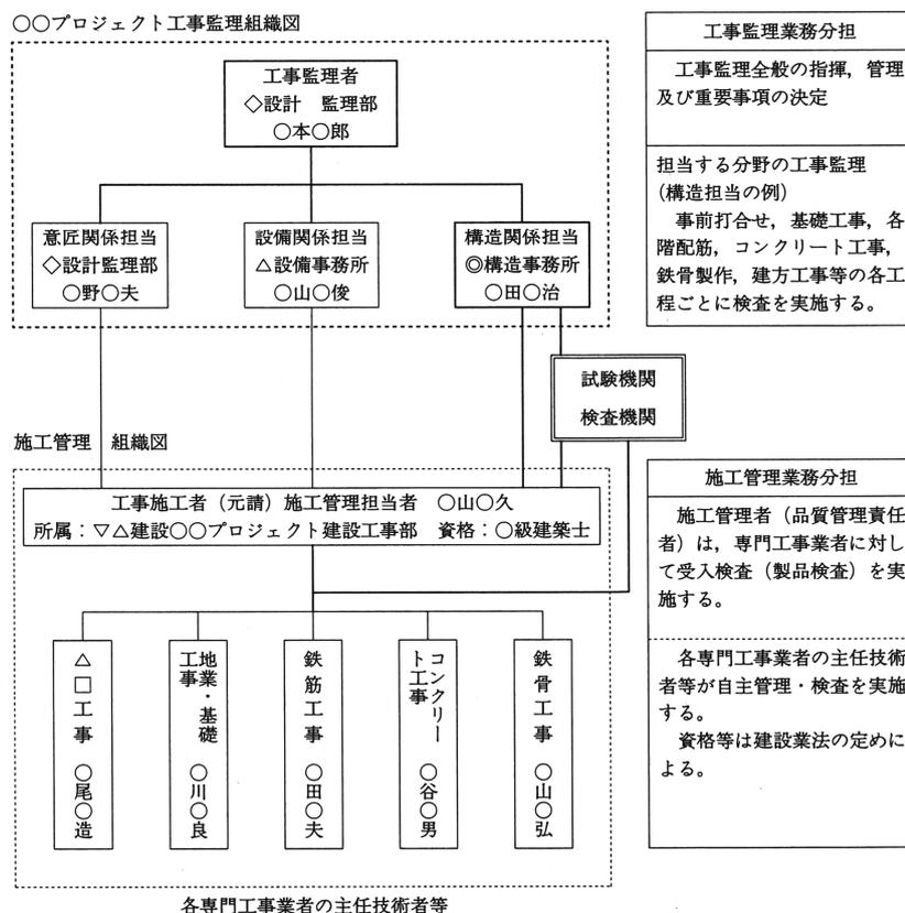
[図] 工事管理体制組織図の例
