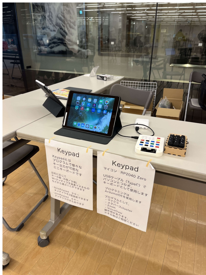
iPhoneをキーで操作する・ミニキーパッド製作 小さなBluetoothキーパッドにプログラミングして iPhoneを操作
