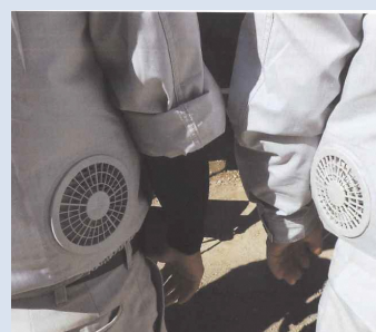
空調機能付きの作業服の活用
