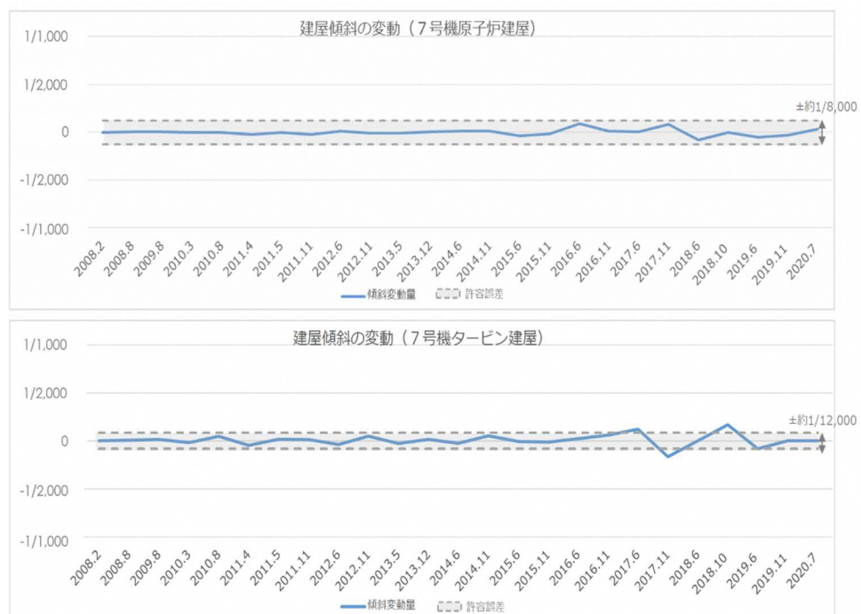
建屋傾斜変化の推移と測量誤差
