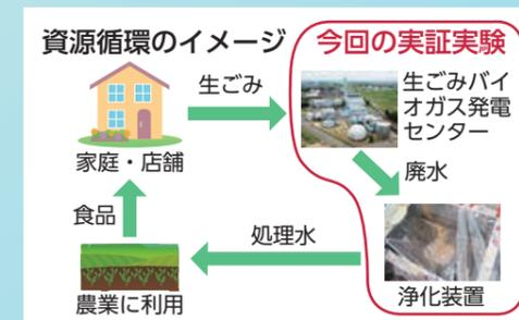
長岡が全国に先駆けて行ってきた資源循環の取り組みである生ごみのバイオガス発電。微生物の働きで生ごみを発酵・分解し、発生したバイオガスを発電に利用しています。1日65トンの処理能力は全国の自治体で最大規模を誇ります。その生ごみ処理で発生した廃水を効率的に浄化する実証実験を、国の研究機関や技大と連携して11月から始めています。
