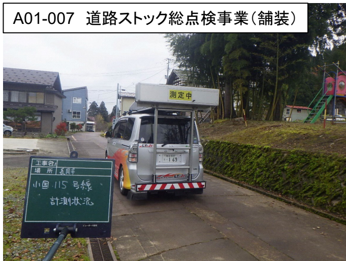
【舗装点検の一例】ひび割れの測定方法
